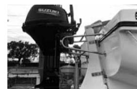
トランサム面にブラケットを取り付け、船外機仕様になっている6メートルカッター
