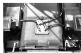
チークデッキを切り開き、燃料タンクをアルミ製からFRP製に交換した状態
