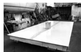
大型のFRP製品を製作するときを使う定盤。およそ2.5×5メートルの大きさ
