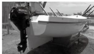
スズキ4スト船外機DF8を搭載したカッターボートのプレジャーボートバージョン
