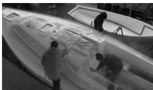
デッキ塗装作業中のスタッフ、経験がモノを言う大変な作業だ
