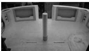
専用のビットが備え付けられ、曳航に最大の配慮がなされた仕様だ
