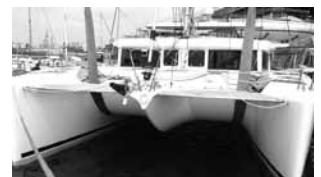
専用の吊り枠を製作し、カタマランヨットも上架可能になった
