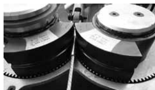
ワイヤーの直径16mmまでのスエーディングが可能となっている
